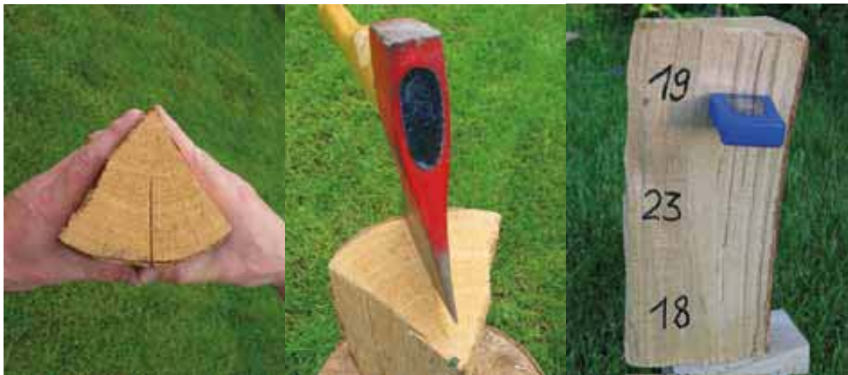
Abb. 5–7: Hersteller unabhängige Messung und Bestimmung der Holzfeuchte von lufttrockenem Brennholz nach der 3-Punkt-Methode (HEISE / KRÄMER 2007)
